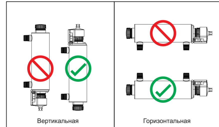
Рисунок 2 Установка системы дезинфекции — вертикальное и горизонтальное положение
